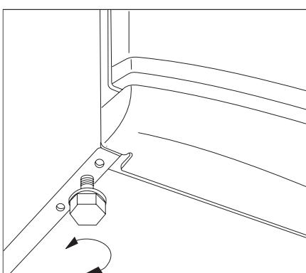
затяните винты. При установке холодильника проследите за тем, чтобы он был расположен горизонтально. Для этого используются 2 регулируемые ножки под передней частью холодильника. Не устанавливайте холодильник так, чтобы на него падал прямой солнечный свет или рядом с кухонной плитой или печью.
